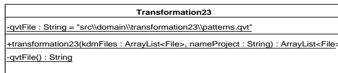
Figura 5.94. Diagrama de Clases iteración 5: Clase Transformation23
